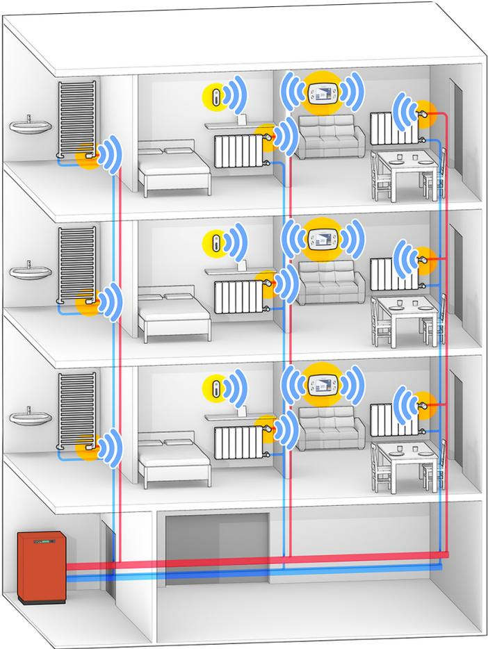
La centralina riceve il segnale dal sensore di temperatura per determinare se è richiesto calore nella singola zona in base alla programmazione impostata. Di conseguenza vengono regolate le valvole presenti nella relativa zona.
