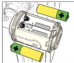
L'alimentazione avviene tramite due batterie tipo 1,5 V stilo AA e ha una autonomia di circa 2 anni a seconda dell'uso.
