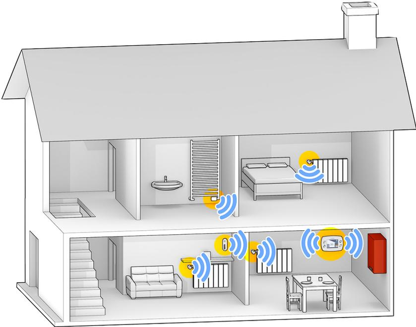
La centralina riceve il segnale dal sensore di temperatura per determinare se è richiesto calore nella singola zona in base alla programmazione impostata. Di conseguenza vengono regolate le valvole presenti nella relativa zona. La caldaia tramite l'apposita uscita relè viene attivata se in almeno una delle zone è richiesto calore.
