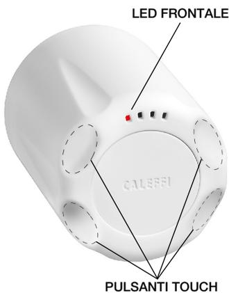
I comandi elettronici cod. 210510, montati sulle valvole di ogni radiatore sono indispensabili per poter gestire le zone dell'impianto di riscaldamento. Modulando la portata di fluido scaldante, regolano la temperatura ambiente a seconda del livello di comfort scelto. La comunicazione tra centralina e comando elettronico avviene ogni 10 minuti (20 minuti in modalità estiva), per preservare la durata delle batterie.
