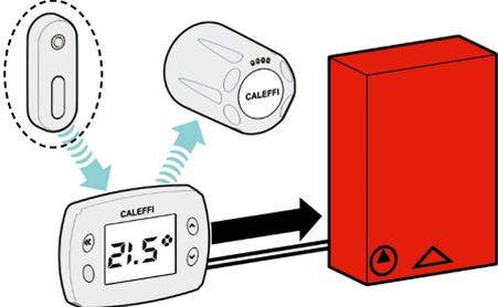
Il sensore di temperatura è opzionale in quanto il comando elettronico è già dotato di sensore di temperatura integrato. È consigliato l'uso del sensore in caso di installazione in situazioni che falserebbero il corretto rilevamento della temperatura. Esempio, in figura, sotto mensole molto sporgenti.
