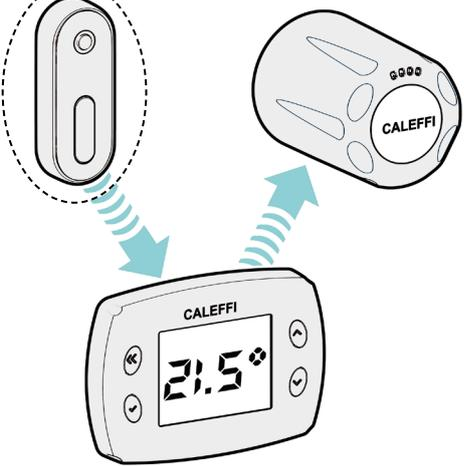
Il sensore di temperatura è opzionale in quanto il comando elettronico è già dotato di sensore di temperatura integrato. È consigliato l'uso del sensore in caso di installazione in situazioni che falserebbero il corretto rilevamento della temperatura. Esempio, in figura, sotto mensole molto sporgenti.
