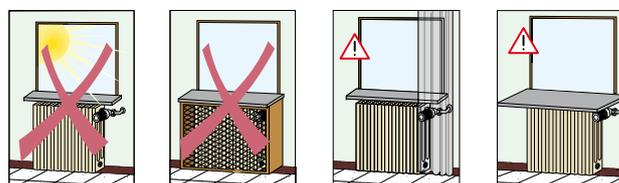
**Si consiglia** di installare un sensore di temperatura ambiente in ogni zona nel caso di installazione in nicchie, cassonetti, dietro tendaggi, all'esposizione diretta dei raggi solari oppure sotto a mensole molto sporgenti che falserebbero il corretto rilevamento della temperatura.
