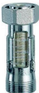
Installato su ogni derivazione del collettore di ritorno, consente di controllare l'esatto valore della portata (l/min.) di ogni singolo anello. I misuratori sono disponibili con scala graduata da 1 a 3,5 l/min oppure da 2 a 8 l/min a seconda delle esigenze impiantistiche.
