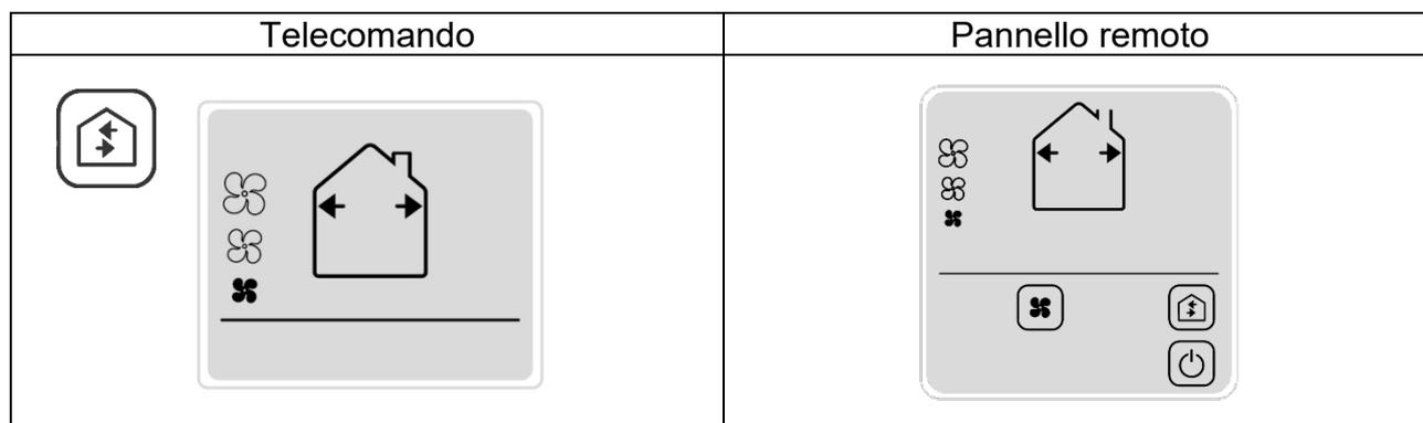
Premendo il relativo tasto tutte le unità funzioneranno costantemente in espulsione con la possibilità di cambiare la velocità di funzionamento in base alle proprie esigenze.
