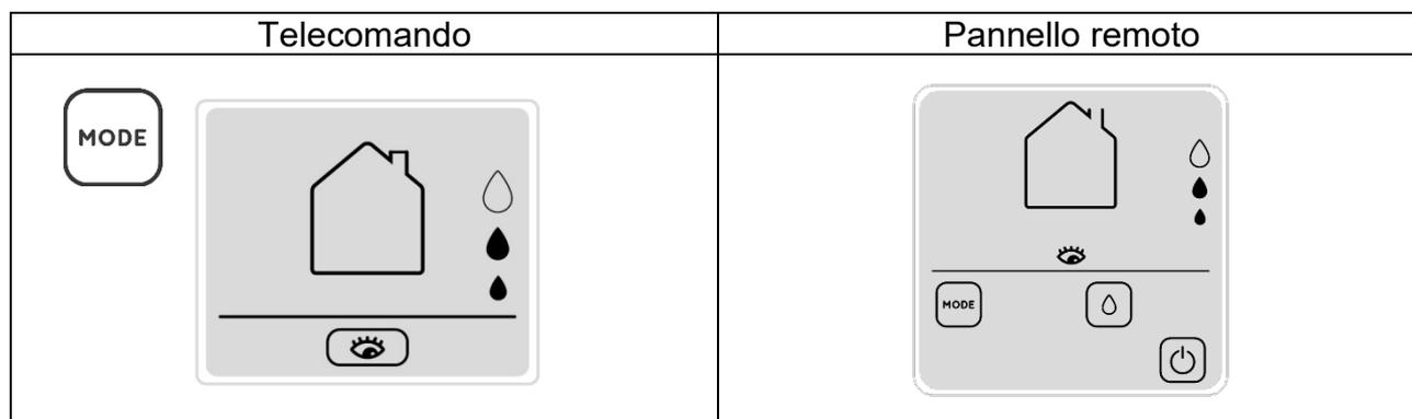
In questa modalità sia il sensore di umidità che il sensore crepuscolare sono attivi, le unità saranno normalmente a riposo con serranda chiusa e i sensori attivi, in modo che quando l'umidità superi la soglia impostata partano in espulsione.
