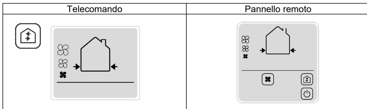
Premendo il relativo tasto tutte le unità funzioneranno costantemente in immissione con la possibilità di cambiare la velocità di funzionamento in base alle proprie esigenze.
