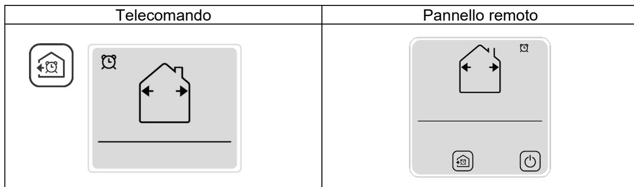
Premendo questo tasto in una qualsiasi delle modalità tutti i prodotti inizieranno ad espellere alla velocità massima per 20 minuti, alla fine del ciclo ritorneranno a funzionare nella modalità precedentemente impostata.
