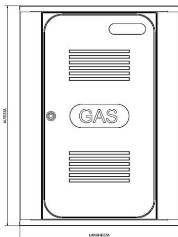
Cassetta per contatori gas con sportello in vetroresina trattato anti UV, telaio e struttura in lamiera zincata; progettato per l'alloggiamento di gruppi di misura del gas con portata volumetrica fino a 6 m<sup>3</sup>/h.
