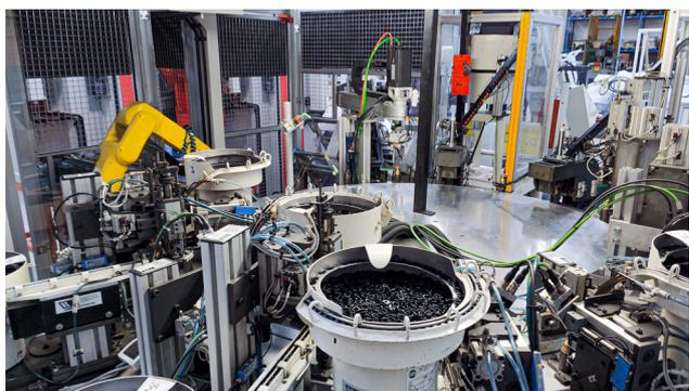
**Figura 27** Tavola rotante dell'isola di assemblaggio.
