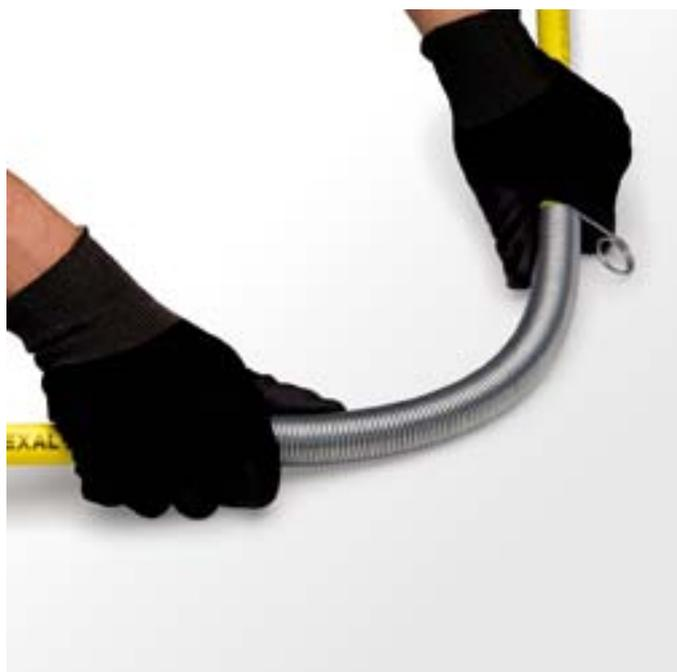
Curvatura diametro 20 mm
