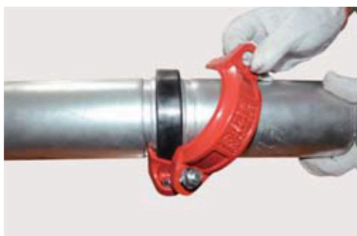
Montaggio del giunto (notare che solo un bullone viene tolto)
