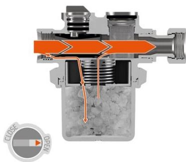
In questa configurazione, il selettore è posizionato in maniera tale che gli o-ring consentano il passaggio di una piccola quantità di acqua sotto di essi. In questo modo, la porzione di acqua dell'impianto che trafila all'interno del bicchiere si satura di polifosfati e silicati mentre il flusso principale prosegue il percorso rettilineo. Il trafileamento di acqua in condizioni di saturazione si ricongiunge poi al principale.
