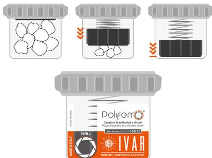
POLIFEMO® semplifica ulteriormente il monitoraggio del consumo dei cristalli di polifosfati nel bicchiere: se l'occhio "si chiude", cioè se l'indicatore di livello ha raggiunto la base del bicchiere, è il momento di effettuare la ricarica.
