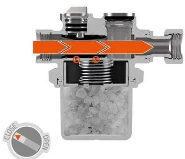
In questa configurazione, il selettore si trova nella posizione in cui gli o-ring sono in tenuta lungo le pareti del corpo filettato. L'acqua procede nel suo percorso senza trafileare nel bicchiere.
