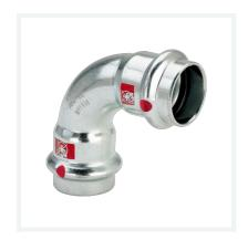
Curva a 90° Prestabo con SC-Contur - estremità a pressare femmina Fornitura O-ring EPDM Modello 1116
