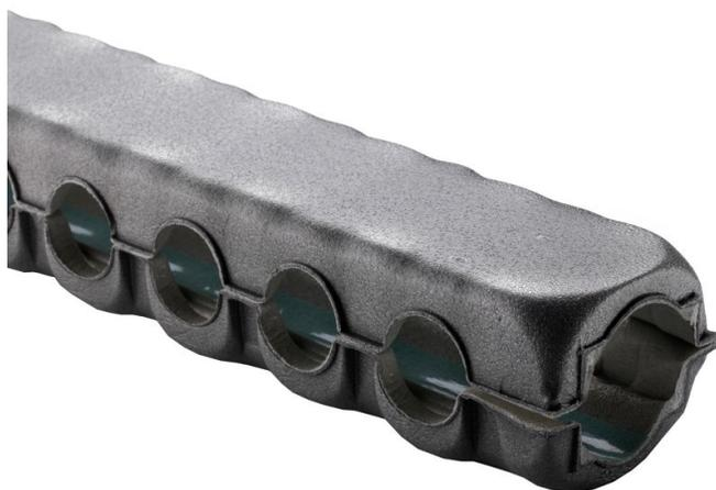
AC 652 è la copertura isolante in PE perfetto per applicazioni isolanti in riscaldamento e in raffrescamento, in quanto evita la formazione di condensa. In caso di applicazione su impianti di riscaldamento, l'utilizzo è consentito fino a una temperatura massima di 85 °C.
